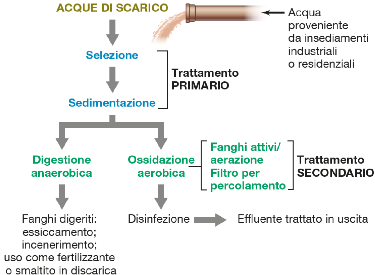
Figura 22.15 Processi per il trattamento delle acque reflue. Gli impianti in grado di attuare un efficace trattamento delle acque reflue prevedono metodi di trattamento primario e secondario come quelli qui schematizzati. L'acqua proveniente trattamento primario va incontro a ossidazione aerobica, mentre i fanghi derivanti dalla vagliatura e dalla sedimentazione primaria, insieme ai fanghi attivi prodotti durante l'ossidazione aerobica delle acque reflue, sono avviati alla digestione anaerobica (Paragrafo 22.8 e Figura 22.22). Il trattamento terziario (non mostrato) può essere introdotto per ridurre i livelli di nutrienti ancora presenti nelle acque prima del rilascio nell'ambiente, mediante abbattimento del BOD, dell'azoto e del fosforo fino a livelli non rilevabili.
