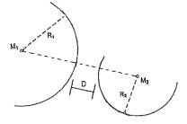
In figura sono assegnati due elementi curvilinei circolari di raggio  $R_1$ = 510m e  $R_2$ = 420m distanti D=12m. La strada assegnata è di tipo C.
