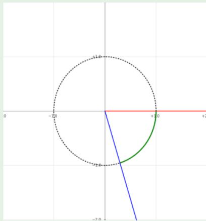
Riportiamo l'angolo in modo che il vertice coincida con l'origine ed il primo lato con la semiretta delle  $x$  positive.
