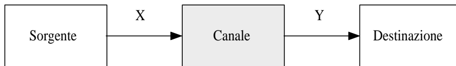
Fig. 2.4. Schema semplificato di un sistema di comunicazione. La sorgente emette simboli X , che sono trasformati dal canale in simboli Y , che giungono alla destinazione.
