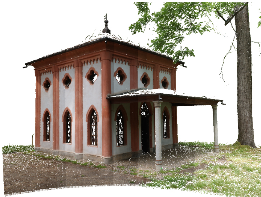
Figura 200 - Nuvola di punti acquisita con un sensore laser scanner terrestre colorata.
