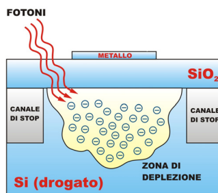
Figura 46 - Schema di un singolo sensore CCD
