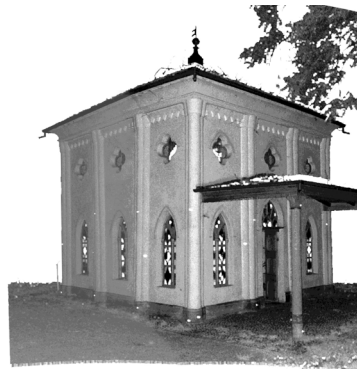
Figura 191 – a) “La fagiania” Parco di Racconigi. b) – nuvola di punti 3D – colore espresso in funzione dell’istogramma dei valori di riflettività. Acquisizione effettuata con il laser scanner Riegl LMS Z420.
