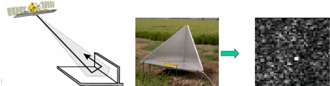
Figura 257 – A destra: principio di riflessione a spigolo. A sinistra un esempio di “corner cube” e la sua rappresentazione all’interno dell’immagine radar.
