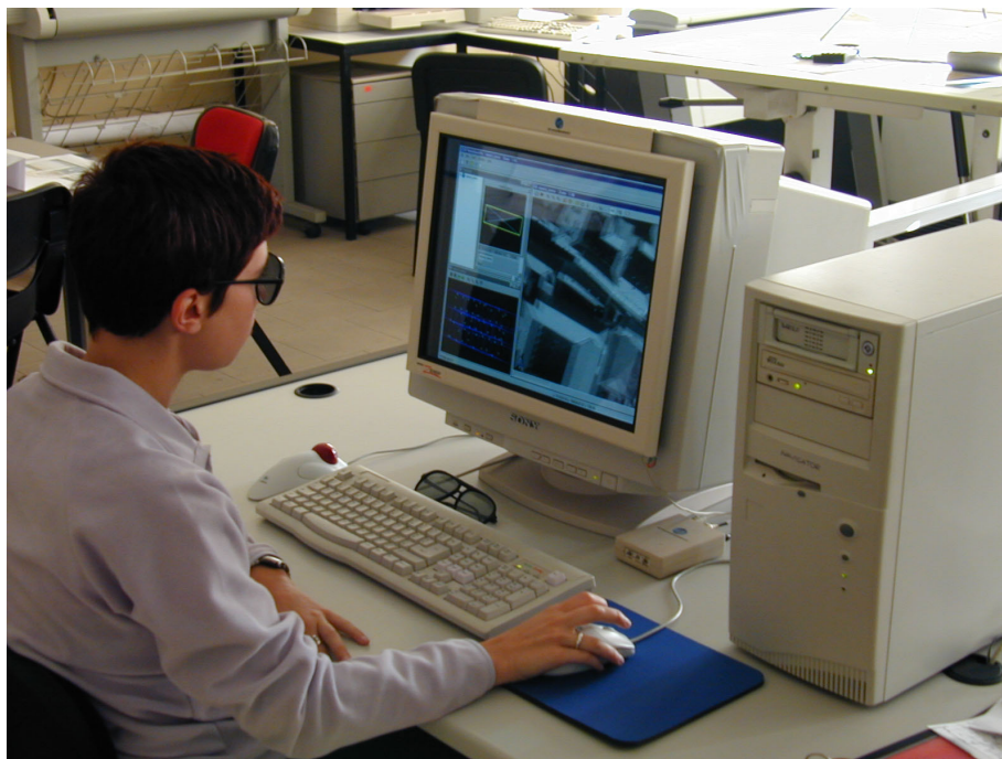
Figura 109 - Apparato di visione stereoscopica a occhiali passivi
