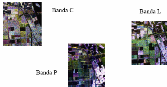
Figura 241 - Immagini radar di intensità relative agli stessi bersagli acquisite in diverse bande spettrali.
