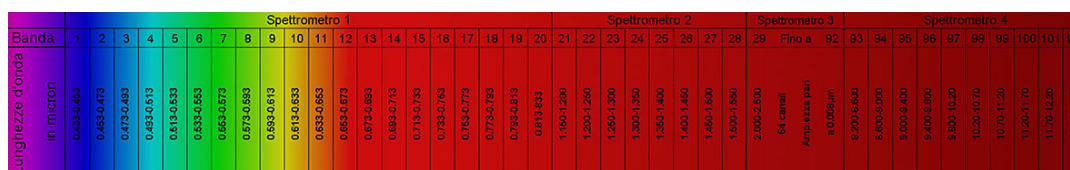
Figura 224 - Dettaglio della copertura spettrale dei 4 spettrometri del sensore MIVIS (fonte: CNR-LARA).
