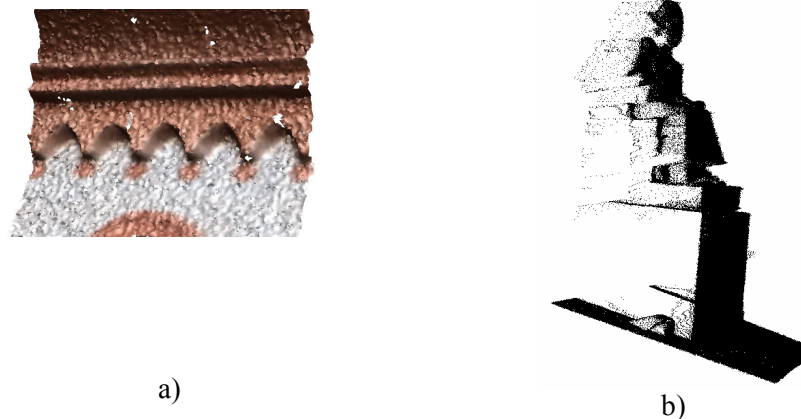
Figura 193 – Visualizzazione del rumore presente tramite una procedura di proiezione dell'immagine sul modello 3D originale. b) Visualizzazione degli errori di acquisizione commessi (outliers e gross errors)
