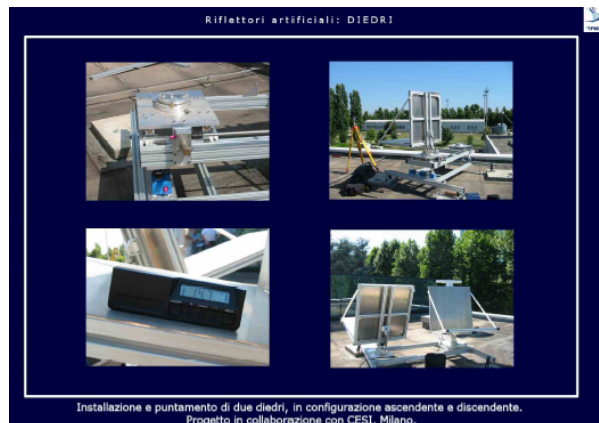
Figura 262 – Riflettori artificiali (da http://www.treuropa.com/ ) di tipo DIEDRO.
