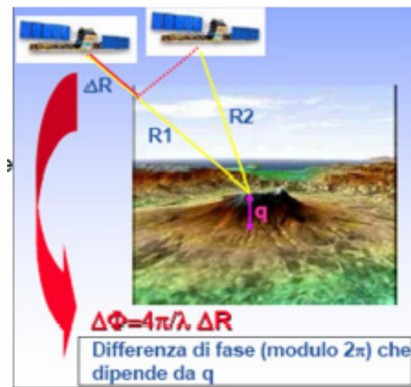
Figura 259 –Schema di acquisizione interferometrica SAR e grandezze coinvolte (da www.smfn.unical.it ).
