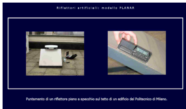
Figura 264 - Riflettori artificiali (da http://www.treuropa.com/ ) di tipo PLANAR.
