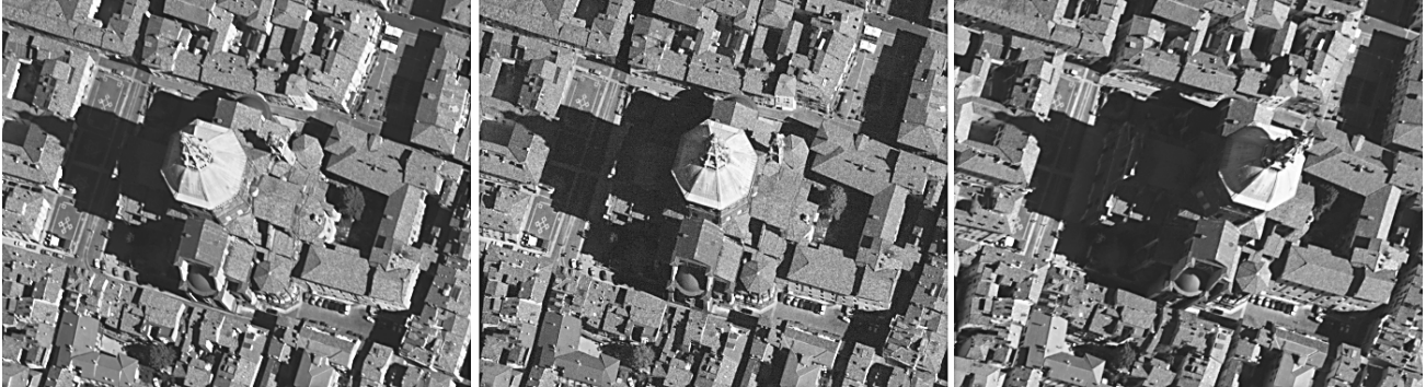
Figura 3 – Visione triscopica fornita dai sensori pancromatici backward, nadir e forward
