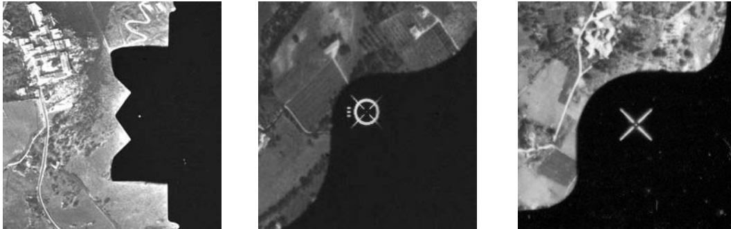
Fig. 11 – Alcuni esempi di marche fiduciali; da sinistra a destra le camere fotogrammetriche Zeiss, Leica e Wild.
