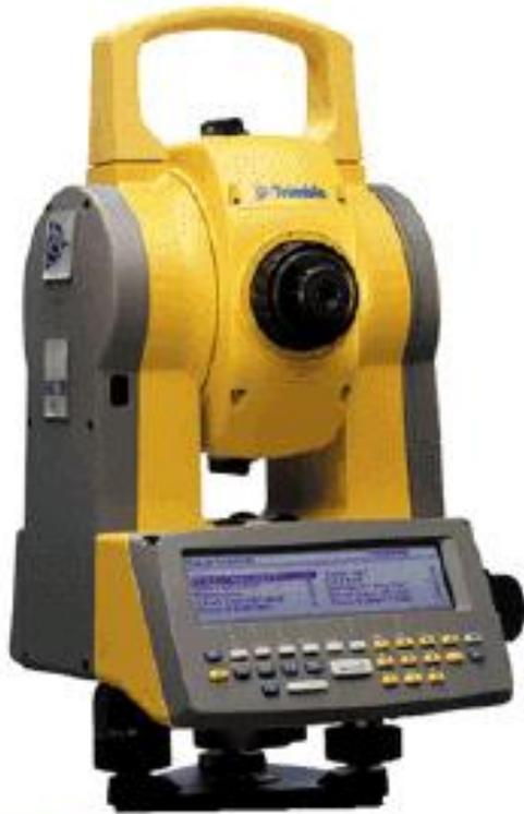
E' l'integrazione di un teodolite e di un distanziometro ad onde, quindi misura:
