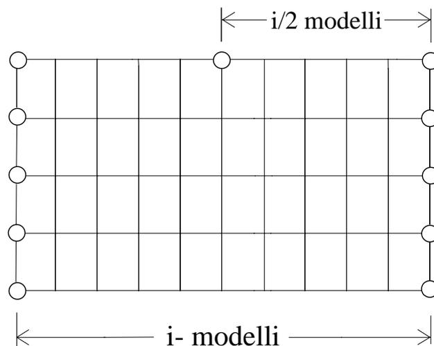
Per aumentare ulteriormente la precisione è buona norma introdurre punti di appoggio altimetrico a intervalli di  $i/2$  modelli (anche solo sul bordo).
