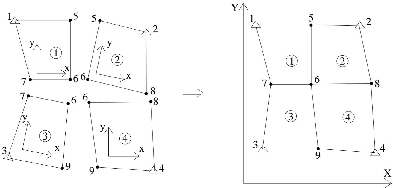
ciascuno dei quattro modelli deve essere trasformato mediante rototraslazione piana con variazione di scala.
