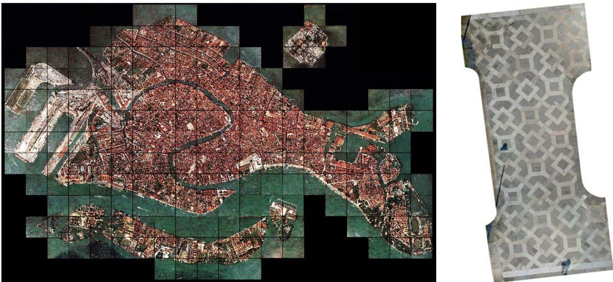
Fig.45: altri esempi di raddrizzamenti: il fotopiano di Venezia, una pavimentazione
