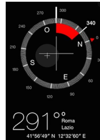
\* L'App Compass utilizza misure dei tre magnetometri IMU del cellulare. Esercizio complementare sarà scrivere un algoritmo che processi le misure dei magnetometri (ottenuti sempre da Matlab Mobile) per ottenere la Prora Magnetica del dispositivo (**task\_4**)
