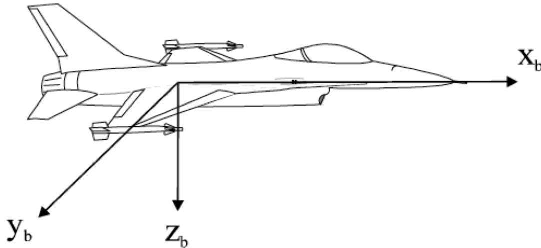
Di conseguenza gli accelerometri misurano le componenti del vettore accelerazione  $\mathbf{f}_b$  rispetto ad una terna solidale all' aeromobile e forniscono, **direttamente le accelerazioni alle quali è sottoposto l' aeromobile.**
