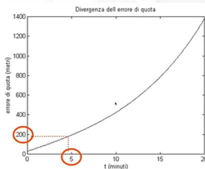
Questo spiega perché le misure di accelerazione del canale verticale vengono trascurate.
