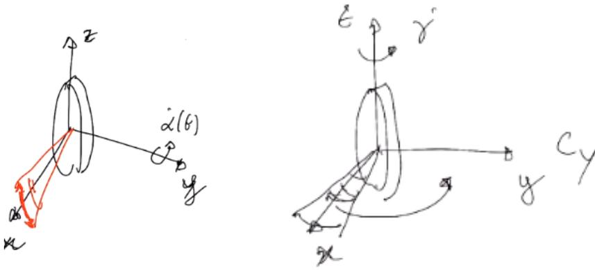
Trascurando il moto di nutazione, si può dire che quando l'asse del giroscopio è libero (due gradi di libertà) e viene applicata una coppia  $C_y$  (o  $C_z$ ) su un asse perpendicolare all'asse di spin (asse d'ingresso), ne deriva una velocità angolare  $\dot{\gamma}(t)$  (o  $\dot{\alpha}(t)$ ) intorno all'asse di uscita z (o y) secondo la relazione:
