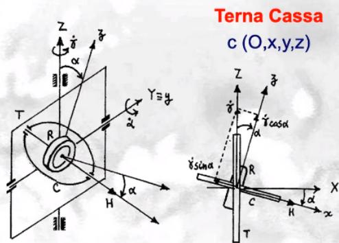
Avremo due momenti angolari: uno legato alla rotazione del rotore (H) e uno legato alla rotazione di tutto il sistema (legato a  $\underline{\omega}$ )
