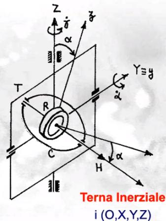
Calcoliamo le componenti di  $\underline{\omega}$  rispetto alla terna cassa (O,x,y,z), ora ruotata:
