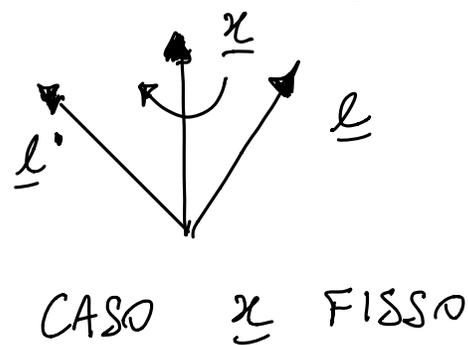
Pertanto la MCD che permette di ottenere le componenti di uno stesso vettore in due SDR - sistema (a) e sistema (b) - ruotati l'uno rispetto all'altro (perchè in moto relativo per esempio) intorno ad un asse istantaneo  $\underline{l}$  di rotazione è:
