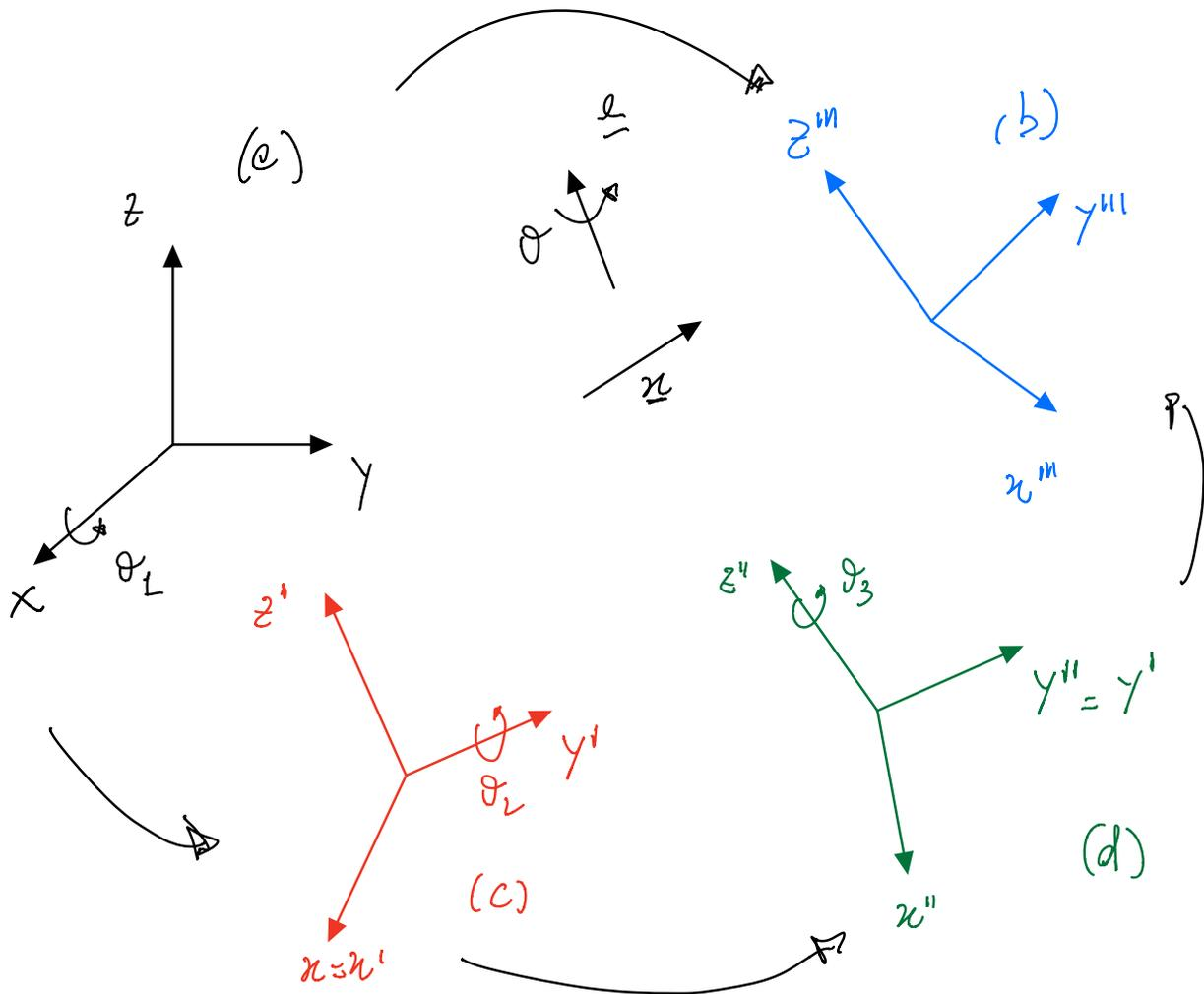
Considerate note le componenti di uno stesso vettore  $\underline{x}$  nel sistema (a), nei successivi SdR le stesse componenti si possono ottenere dalle relazioni:
