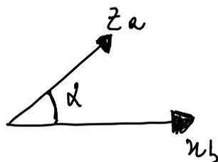
Nel caso in cui le rotazioni avvengono intorno agli assi cartesiani allora le MCD si indicheranno con  $R_x(\theta)$  dove il pedice stabilisce l'asse di rotazione e l'argomento rappresenta l'angolo di rotazione.
