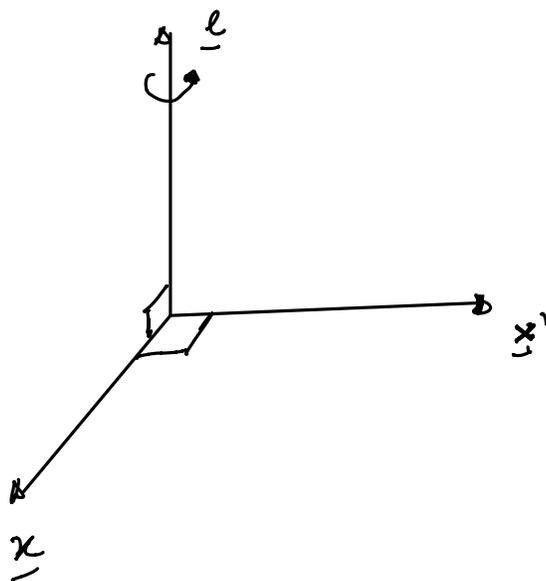
dopo la rotazione il vettore  $\underline{x}$  si disporrà secondo la direzione  $\underline{x}'$  in modo che la terna  $\underline{x} \hat{\underline{e}} \underline{x}'$  sia levogira, pertanto la relazione vettoriale è espressa dalla relazione
