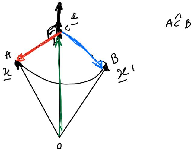
Dopo la rotazione il vettore  $\underline{x}'$  può essere ottenuto dalla somma vettoriale del vettore  $\vec{OC}$ , diretto lungo  $\hat{e}$  e di modulo pari alla proiezione di  $\underline{x}$  lungo tale direzione, e del vettore  $\vec{CA}$  perpendicolare ad  $\hat{e}$  e ruotato di  $\theta$  rispetto al vettore  $\vec{CA}$ .
