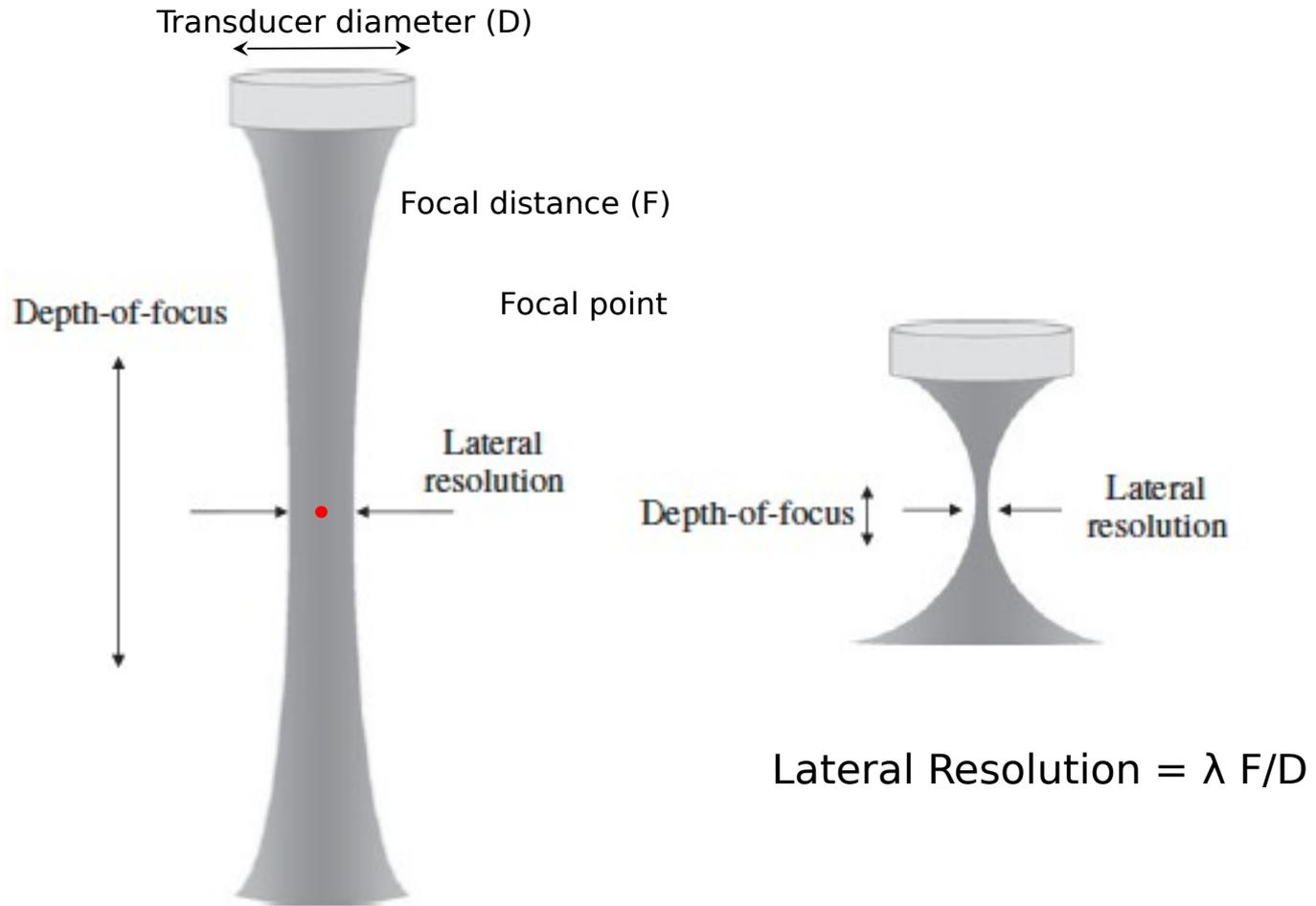
**Bilanciamento fra profondità di fuoco e risoluzione laterale per trasduttori a singolo elemento weakly-focused (sinistra) e strongly-focused (destra)**
