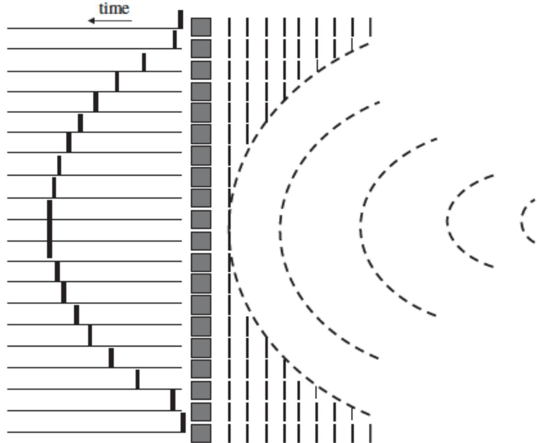
**Beam-forming durante la trasmissione**
