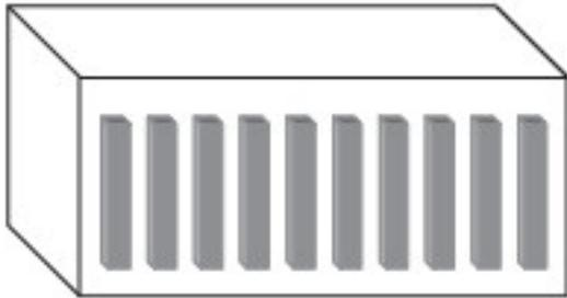
**Array 1D costituito da elementi piezoelettrici rettangolari**
