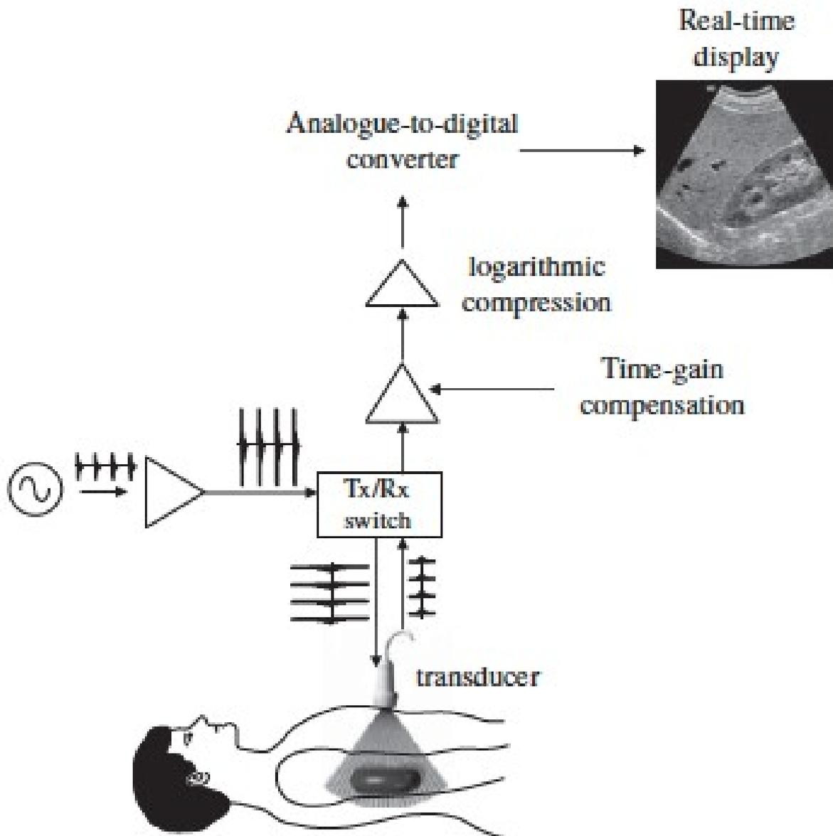
**I principali elementi di un sistema di imaging ecografico**
