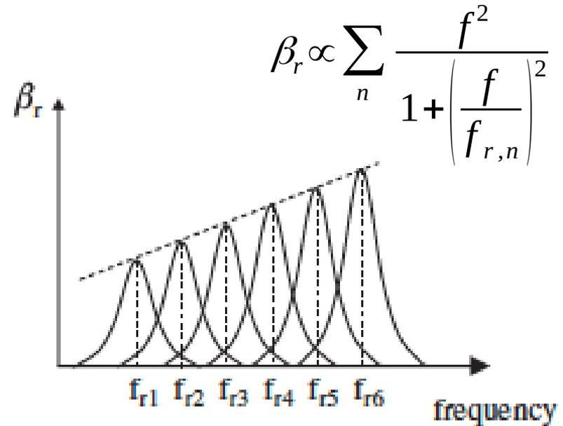
Andamento del coefficiente di assorbimento  $\beta_r$  in caso di tessuto omogeneo (sinistra) e realistico (destra) in cui sono presenti più frequenze di rilassamento.
