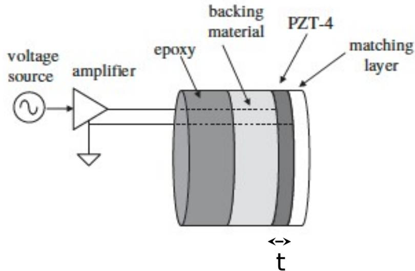
Un trasduttore on un elemento PZT (piezoelettrico) piatto
