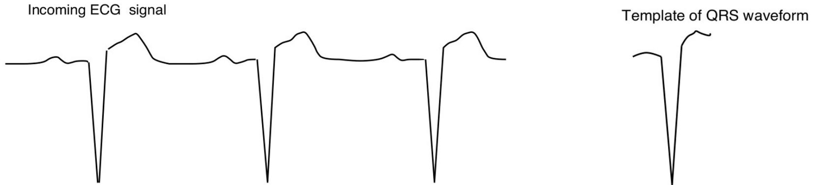
Ad ogni segmento del dato registrato viene sottratto il segnale template. Quando vi è l'allineamento (temporale ed in ampiezza) il risultato sarà identicamente nullo.
