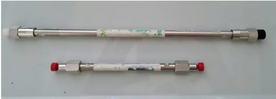
Di solito vengono utilizzate anche una o più colonne di protezione, che vengono poste tra iniettore e la colonna analitica
