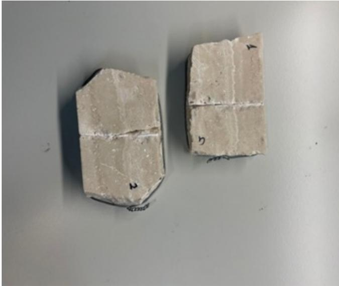
Test per valutare la precipitazione di carbonato lungo una frattura creata artificialmente
