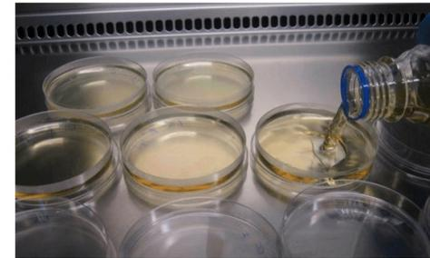
Le soluzioni dopo essere state preparate sono sterilizzate in autoclave a 120°C alla pressione di 1 bar per 15 minuti (mentre l'urea è stata sterilizzata per filtrazione).
