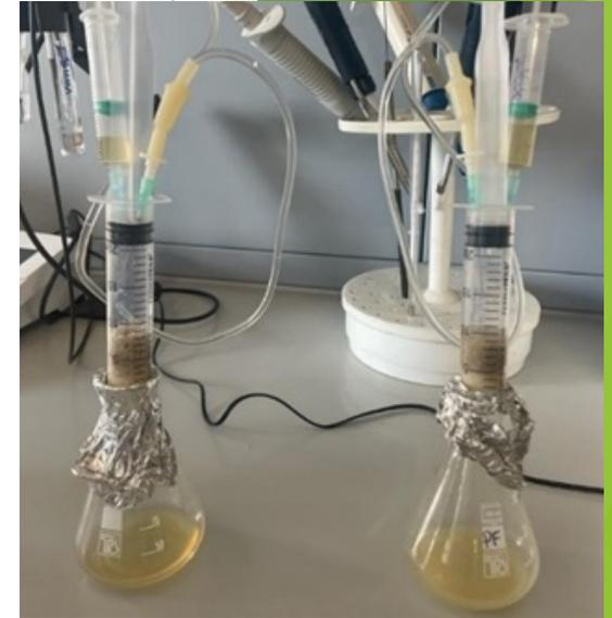
Test per valutare la capacità di consolidamento di frammenti di marmo molto friabile, definito “zuccherificato”
