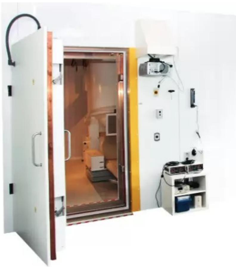
Camera schermante (mu-metal, alluminio e rame) per disturbi a medio/alta frequenza.
