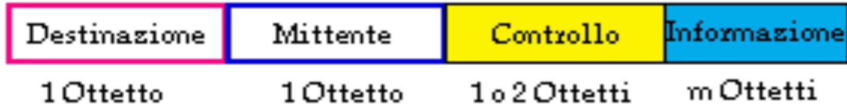
Gli indirizzi **LLC**, lunghi un byte (SSAP e DSAP Source e Destination Service Access point), indicano il protocollo di livello superiore che deve ricevere quel pacchetto (**LLC** offre un supporto **multiprotocollo**).
