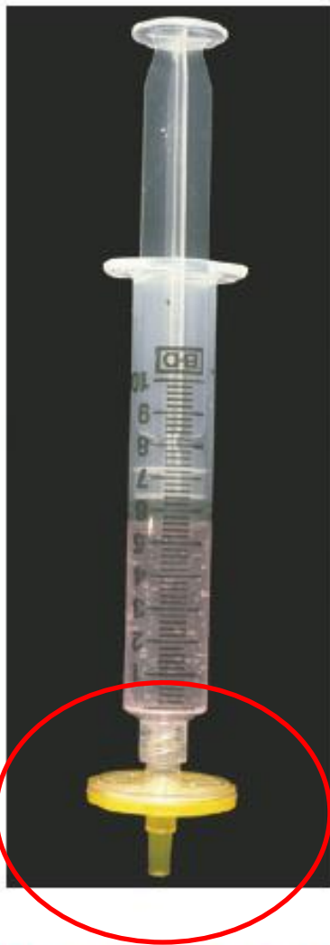
Figura 14.7 Membrane filtranti. Unità monouso con membrane filtranti presterilizzate assemblate. Sinistra: sistema filtrante per piccoli volumi. Destra: sistema filtrante per grandi volumi.
