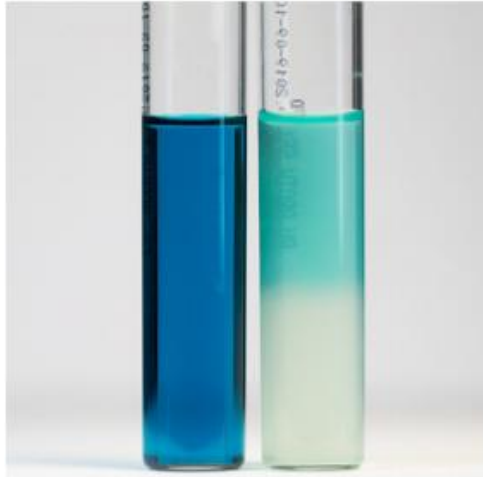
Rappaport Vassiliadis (RV) Broth – da sinistra: provetta non inocolata, crescita di S. Enteritidis
