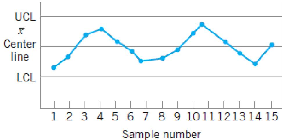
Si noti che le medie del campione rientrano tutte nei limiti di controllo, ma presentano un comportamento ciclico. Tale modello può indicare un problema con il processo come affaticamento dell'operatore, consegne di materie prime, accumulo di calore o sollecitazioni e così via.
