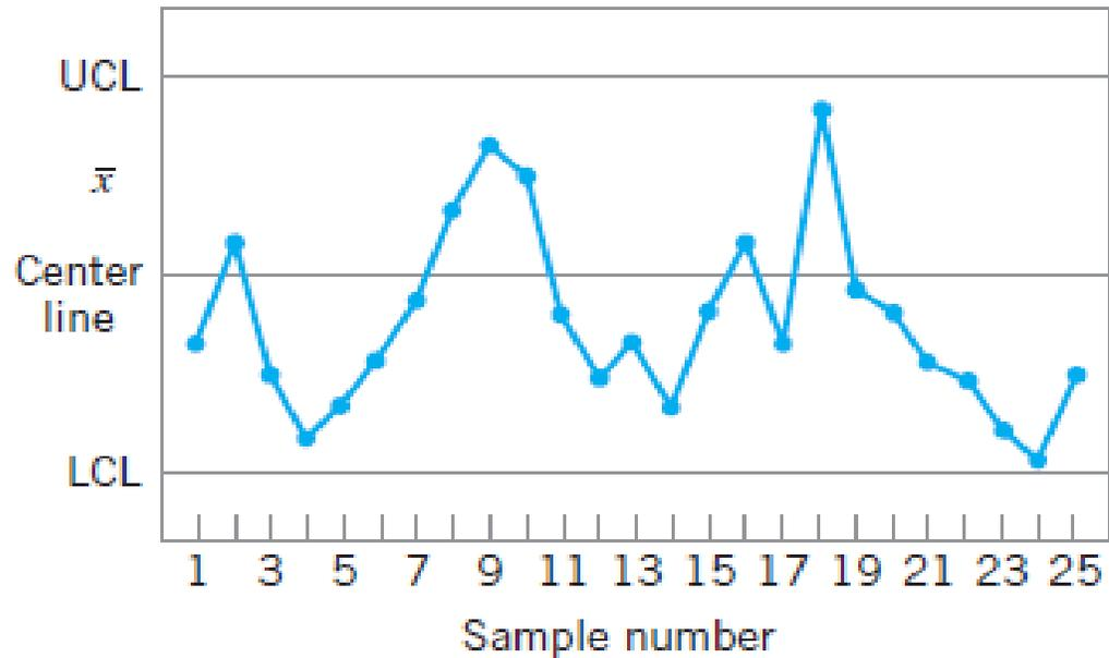
In particolare, notiamo che 19 di 25 punti vengono tracciati sotto la linea centrale, mentre solo 6 di essi sopra.
