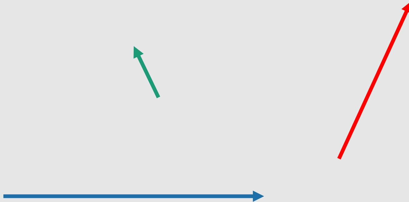
Metodo punta coda: trasliamo parallelamente a se stessi I vettori, uno per volta, facendo coincidere il punto di applicazione con l'estremo libero del precedente vettore
