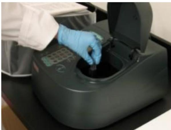
Figura 19 – Tipico spettrofotometro utilizzato per i saggi di determinazione proteica e enzimatica
