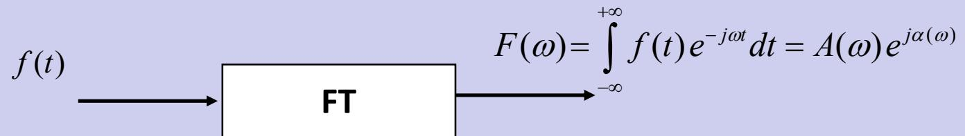
$$f(t) = \frac{1}{2\pi} \left[ \int_{-\infty}^{+\infty} A(\omega) \cos[\omega t + \alpha(\omega)] d\omega + j \int_{-\infty}^{+\infty} A(\omega) \sin[\omega t + \alpha(\omega)] d\omega \right]$$
