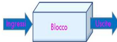
**Figura 3.1:** Definizione di blocco tramite la relazione Ingresso/Uscita.
