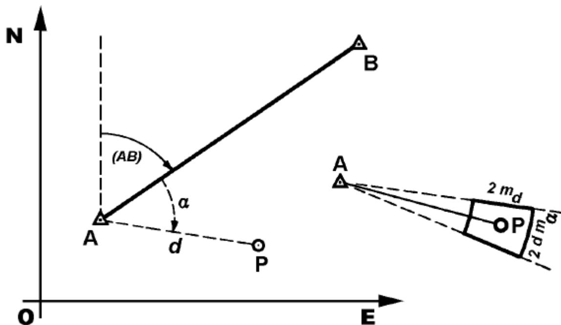
Messo in stazione lo strumento sul punto  $A$  si misura l'angolo  $\alpha$  e la distanza  $d$  dal punto incognito  $P$  avendosi così tutti i dati necessari per determinarne le coordinate.
