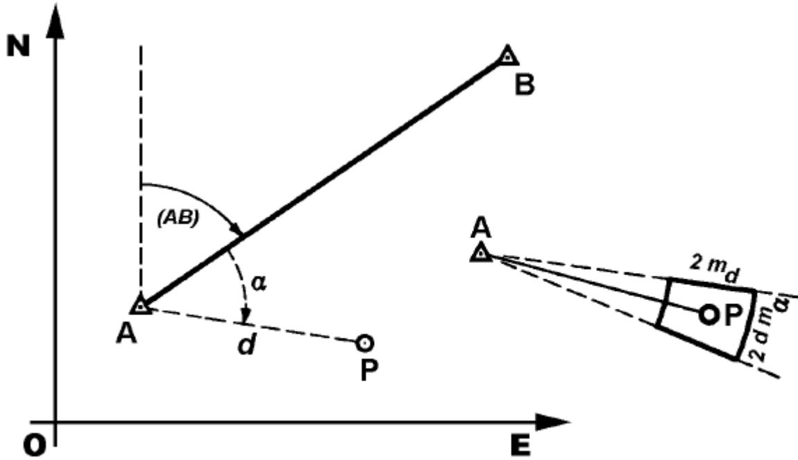
Per determinare la posizione di un punto basta avere a disposizione due punti di coordinate note, uno su cui fare stazione ed il secondo per orientarsi.
