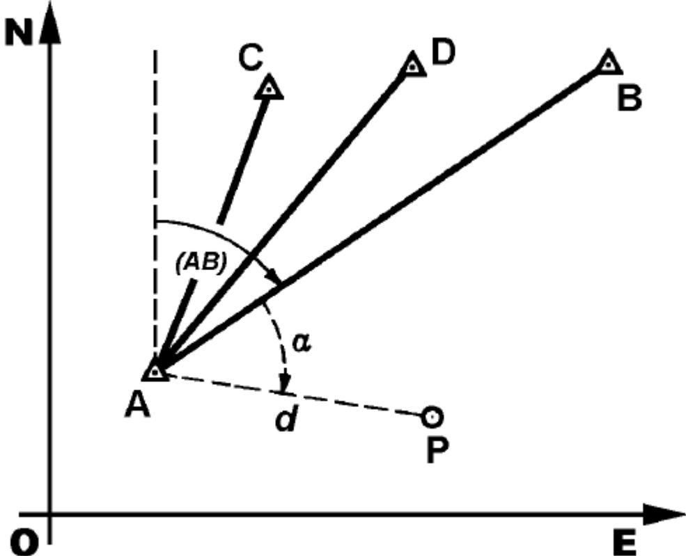
Nell'esempio indicato in Fig. 4 collimando da A più punti di coordinate note e determinando gli angoli  $\alpha_1 \alpha_2 \alpha_3$  che le direzioni AB, AC e AD formano con AP, nonché ovviamente misurando la distanza  $d$ , si avranno a disposizione tre possibilità per calcolare le coordinate incognite di P.
