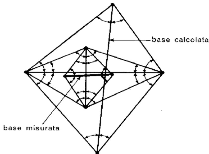
Dalla base misurata, mediante una triangolazione di sviluppo eseguita con la massima precisione (per ogni angolo si eseguivano fino a 36 reiterazioni) si giungeva ad inglobare un lato della triangolazione del primo ordine che diveniva così la *base calcolata*.
