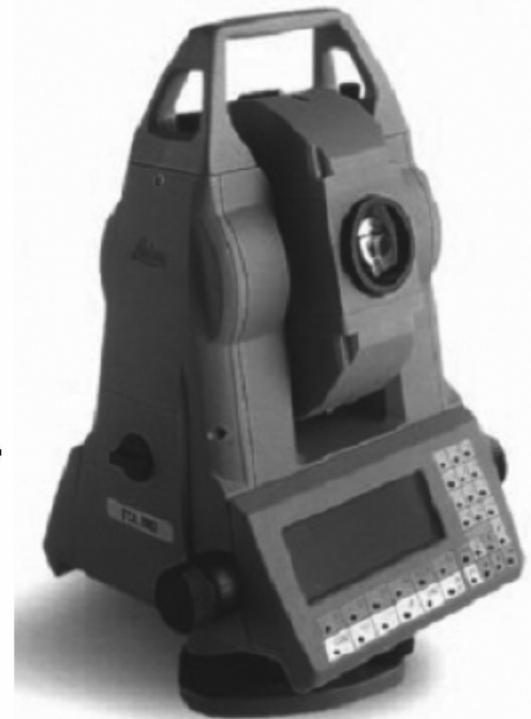
I tacheometri sono strumenti analoghi ai teodoliti, da cui si differenziano essenzialmente per la precisione intrinseca, oltre che per l'assenza (in linea di massima) di un reticolo distanziometrico.
