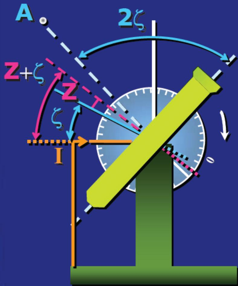
Per collimare il punto  $A$  devo ruotare il cannocchiale di un angolo  $2\zeta$
