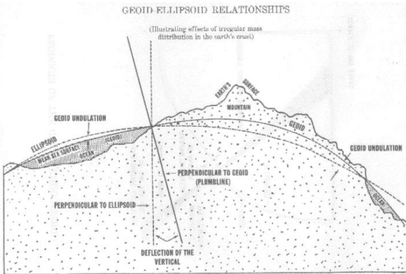
La normale al geode, detta verticale, coincidente con la direzione del filo a piombo, non necessariamente coincide con la normale ovvero perpendicolare all'ellissoide. L'angolo tra le due normali si chiama deflessione della verticale.
