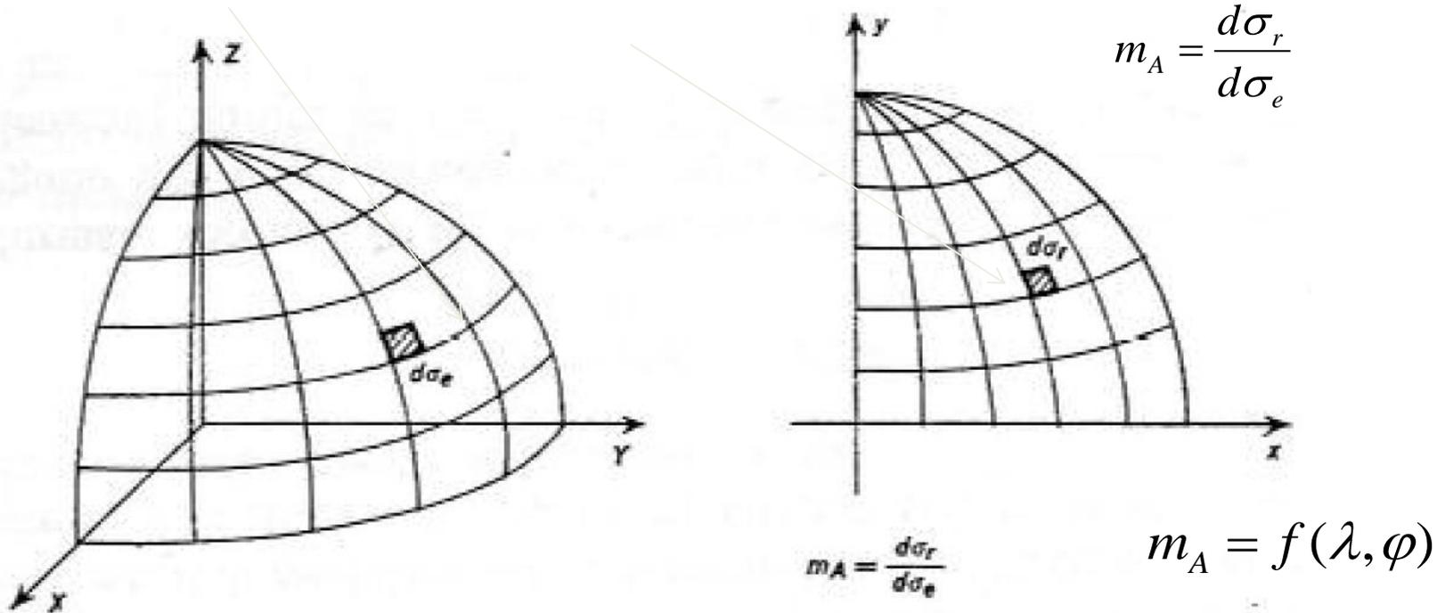
Il modulo di deformazione areale dipende solo dalle coordinate (ellissoidiche o sferiche) del punto.
