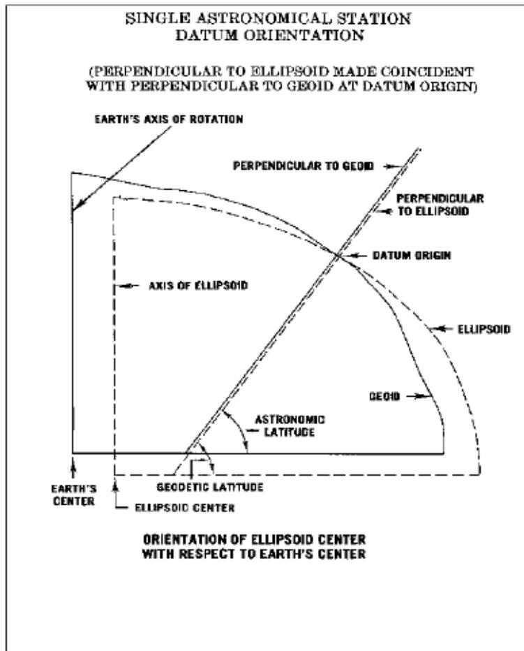
L'ellissoide può essere orientato rispetto al geode in modo che in un certo punto sia garantita la tangenza tra le due superfici e la coincidenza tra la verticale geoidica e la normale ellissoidica (orientamento forte). La cartografia prodotta proiettando sul piano tale superficie ellissoidica risulterà particolarmente affidabile per tutto il territorio circostante il punto di tangenza.
