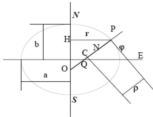
Gran Normale, o raggio di curvatura maggiore (intersezione dell'ellissoide con il piano contenente la verticale al punto **P** e ortogonale al piano contenente il meridiano)
